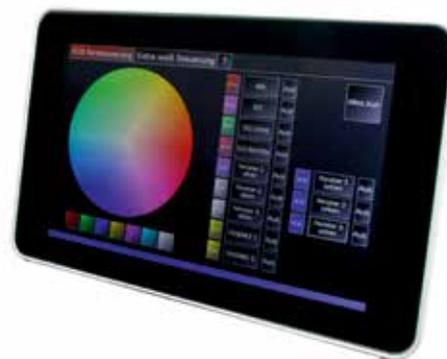
**Abb.:** Eine Sonderlösung war für die Schaufenster des Werkhauses erforderlich. Drei »Raspberry Pi3« fungieren als kleine DALI-Server. Ein vierter mit Touch-Display wurde als Bedienpanel für die lokale Beleuchtung eingerichtet. (Foto: Code Mercenaries)
